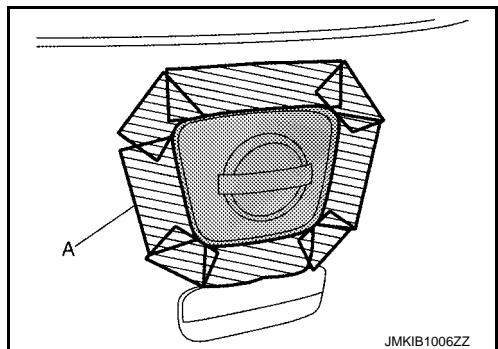
4. 用拆卸工具 (A) 和切刀 (B) 切割后背门饰件固定双面胶带。
