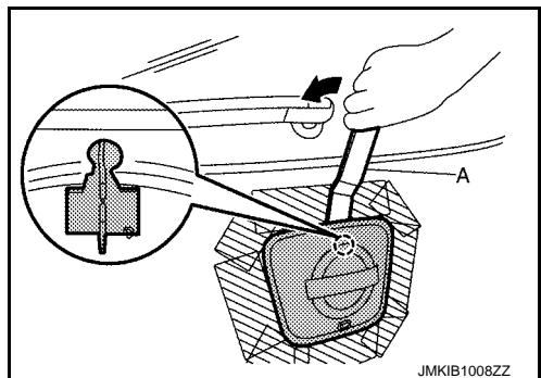
6. 拆下后背门饰件后, 拆下以下零件。
