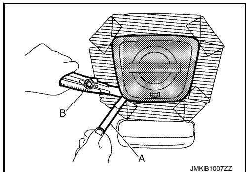
5. 使用拆卸工具 (A) 拆下后背门饰件上侧的后背门饰件固定卡子, 然后拆下后背门饰件。
